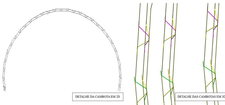
Figura 77 - Detalhe das cambotas no AllPlan
