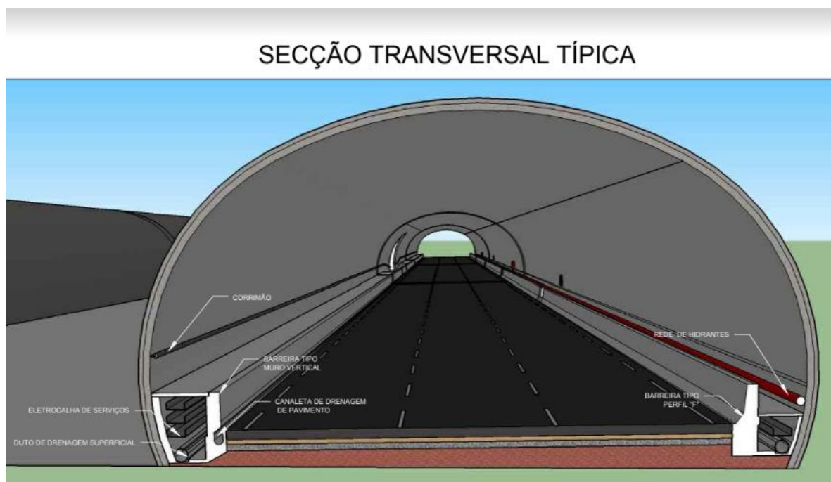
Figura 15 – Projeto original: elementos internos do túnel (Memorial de Cálculo Túnel Engenho Velho e Boiúna)
